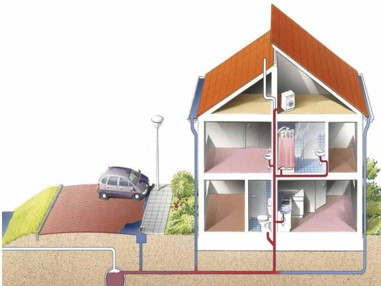
Gemengd rioelstelsel (Paul Maas, Tilburg/Stichting RIONED)
